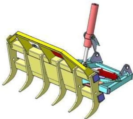
Корчеватель предназначен для выкорчевывания пней и камней и их транспортировки до границы полосы расчистки.
