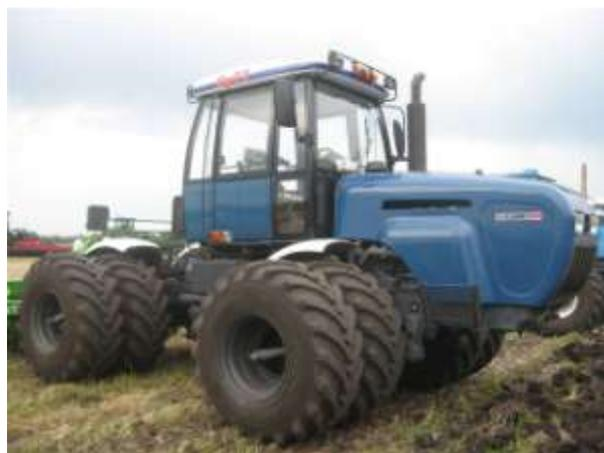
Применение спаренных шин снижает удельное давление на почву, что в 1,5-2 раза уменьшает степень уплотнения по следу трактора, повышает проходимость агрегатов при повышенной влажности и увеличивает их тяговое усилие. Это особенно важно в ранние сроки проведения весенне-полевых работ при высоком содержании почвенной влаги.
