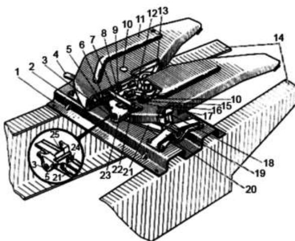
1 – основание седла; 2 – предохранитель саморасцепки; 3, 15, 19 – масленка; 4 – рычаг управления расцепкой; 5 – ось балансира; 6, 16, 17 – пружина; 7 – защелка; 8 – кулак запорный; 9 – палец кулака направляющий; 10 – ось захвата; 11 – седло; 12, 13 – захват; 14 – лонжерон; 18 – ограничитель бокового наклона седла; 20 – кронштейн; 21 – балансир; 22 – ось рычага управления; 23 – кронштейн седла; 24 – клин оси балансира; 25 – гайка клина
