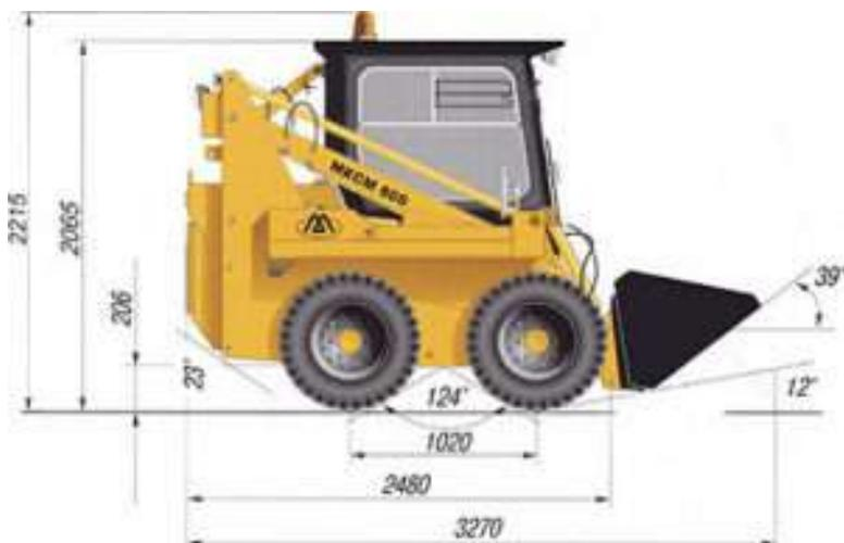
Предназначен для погрузки, перемещения и других работ с широким спектром грузов – удобрения, сыпучие материалы (опилки, стружка), снег, различные виды грунта. Кроме того, ковш может использоваться в качестве отвала для перемещения и разравнивания грунта.
