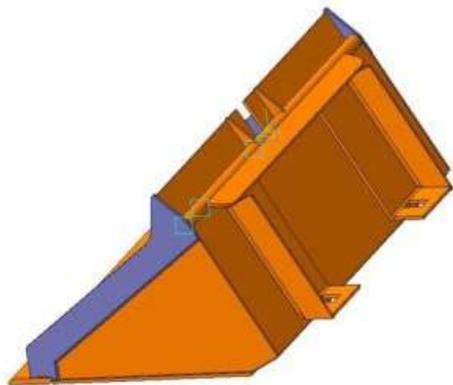
Ковши для мини-погрузчиков – это оборудование, которое может использоваться для выполнения различных работ. Ковш представляет собой специальную емкость, состоящую из днища, задней и двух боковых стенок.
