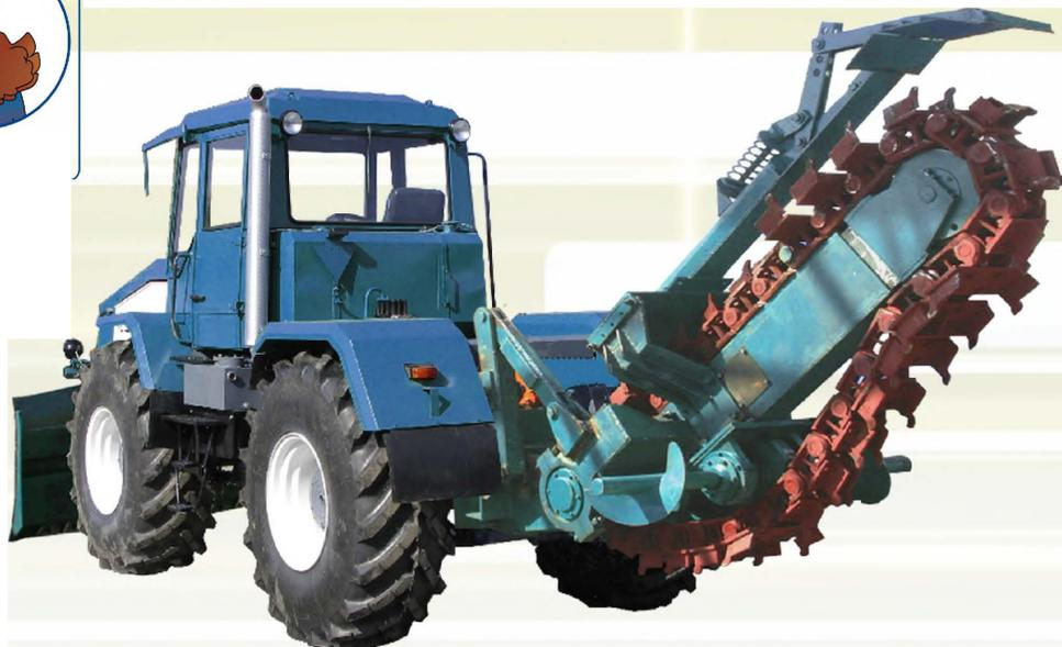
Трактор ОртЗ-150К с навесным щелерезным оборудованием. Предназначен для рытья траншей прямоугольного сечения под трубопроводы различного назначения, кабельные линии связи и электропередач, а также прокладки других коммуникаций, в т.ч. в мерзлых и тяжелых грунтах. Оборудован бульдозерным отвалом. Возможна комплектация сменным дискофрезерным рабочим оборудованием для одновременного прорезания двух щелей в мерзлых грунтах и асфальтобетонных покрытиях.
