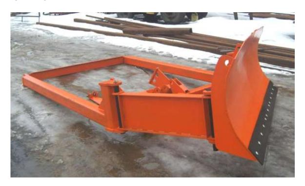
Навесное бульдозерное оборудование поворотное предназначено для установки его на трактор Т-150Г и ДТ-75, применяется на различных дорожно-строительных земляных работах, а именно, для разработки и перемещения грунтов 1 и 2 категории, засыпки траншей и котлованов, перемещения сыпучих строительных материалов, строительства силосохранилищ, расчистки дорог от снега в районах с умеренным климатом при температуре не ниже минус 40°С.
