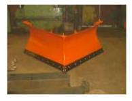
Отвал снегоуборочный предназначен для установки его на следующий модификацию тракторов:
