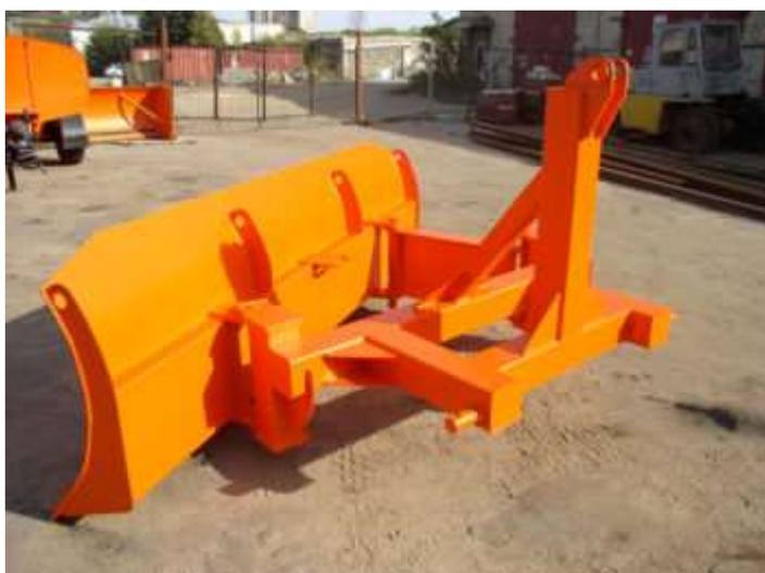
**НБО-34 отвал на трех точечную навеску трактора КИРОВЕЦ (К700, К701, К702, К704, К744 и другие модели)**
