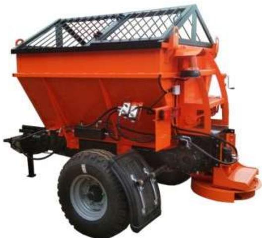
Пескоразбрасыватель предназначен для распределения (разбрасывания) на тротуарах, пешеходных дорожках, дворовых территориях и поселковых дорогах сухой мраморной и гранитной крошки, песчано-соляной смеси, чистого песка и смесей невысокого качества.
