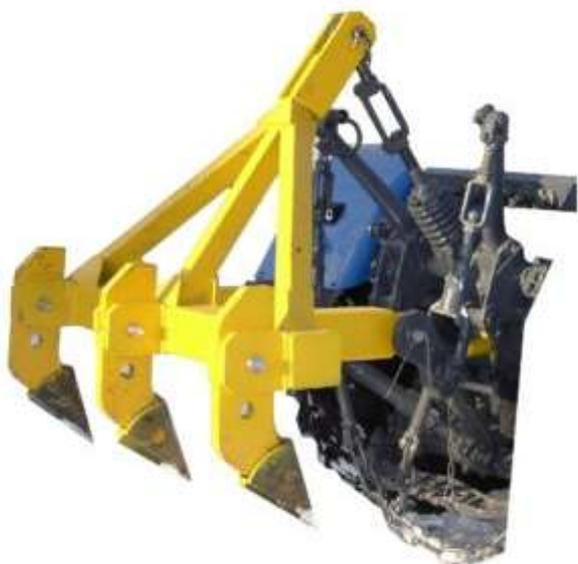
Рыхлители являются навесными рабочими органами к трактору и предназначены для предварительного рыхления тяжелых, каменистых или слежавшихся, а также мерзлых грунтов для облегчения последующей работы землеройно-транспортных машин. Рыхлители применяют также для удаления из грунта корней, остатков пней и камней после работы корчевателя и для разрушения (киркования) старых дорожных покрытий при ремонте лесовозно-автомобильных дорог.
