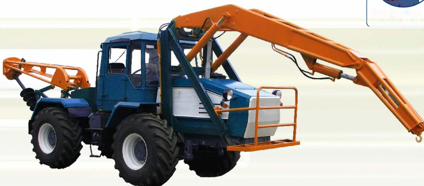
Трактор ОрТЗ-150К с бурильно-крановым оборудованием БКМ-2М, предназначен для бурения вертикальных скважин в немерзлых грунтах I...III категорий и установки опор ЛЭП ВЛ 0,4...10 кВ.
