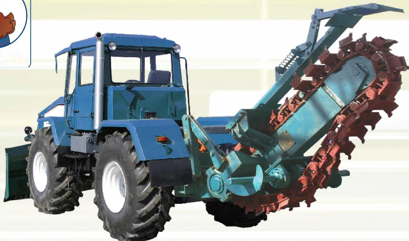
Трактор ОпТЗ-150К с навесным щелерезным оборудованием. Предназначен для рытья траншей прямоугольного сечения под трубопроводы различного назначения, кабельные линии связи и электропередач, а также прокладки других коммуникаций, в т.ч. в мерзлых и тяжелых грунтах. Оборудован бульдозерным отвалом. Возможна комплектация сменным дискофрезерным рабочим оборудованием для одновременного прорезания двух щелей в мерзлых грунтах и асфальтобетонных покрытиях.
