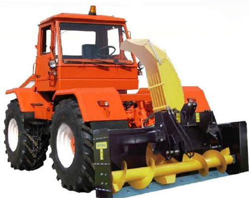
**Роторный снегоочиститель** на базе трактора OpT3-150K. Предназначен для очистки дорог от свежего и слежавшегося снега. Высота очищаемого снежного покрова – 0,9 м, ширина захвата – 2,45 м, дальность выброса снега – 5-40 м, производительность – 12-16 м<sup>3</sup>/мин. Возможна поставка вместе со сменным оборудованием – роторным измельчителем, цепным кусторезом, бульдозерным отвалом.
