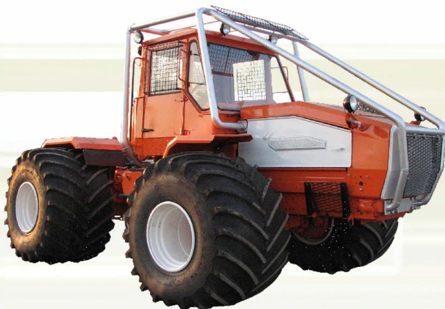
Трактор лесопромышленный повышенной проходимости, оборудован каркасом безопасности, защитными сетками стекол кабины и радиатора, защитой пневмокамер тормозной системы.
